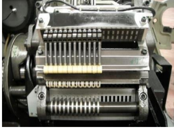
Resim 2.9. Armürlü ağızlık açma sistemi
