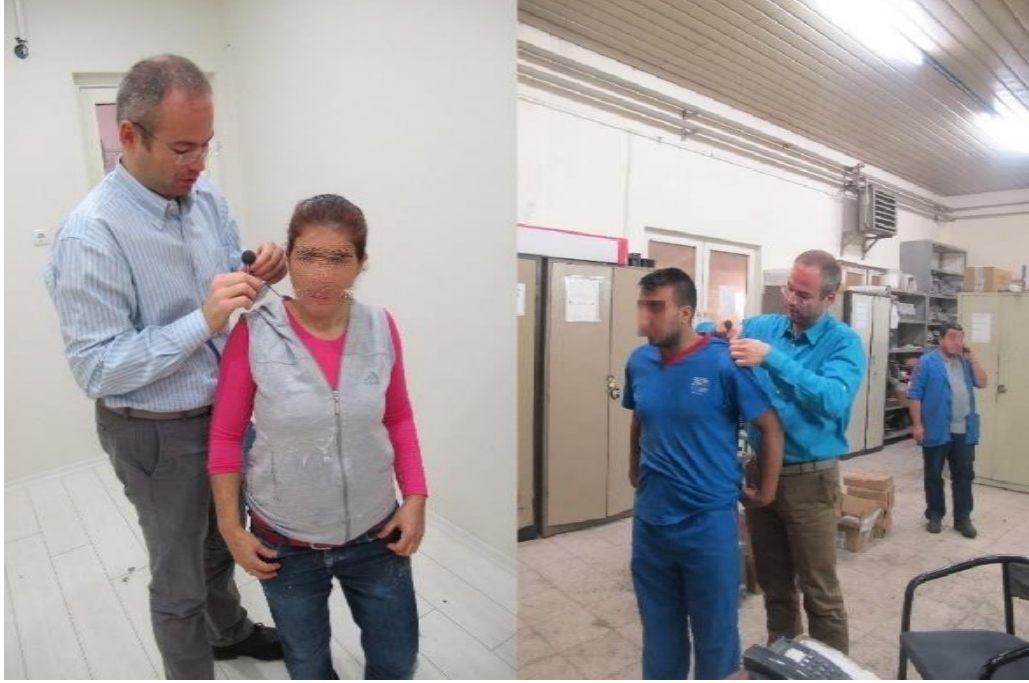
Resim 3.3. Mikrofonun alıřanların zerine takılması
