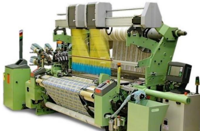
Resim 2.10. Elektronik jakarlı dokuma makinesi
