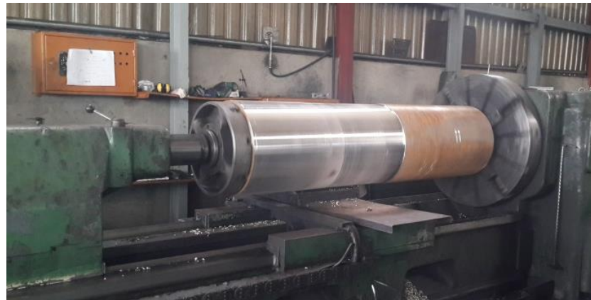
Resim 2.6. Santrifüj döküm ile elde edilen parçanın temizlenmesi işlemi
