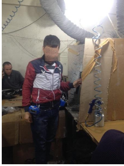
Resim 3.1 Örneklem Pompası ve Konumu
