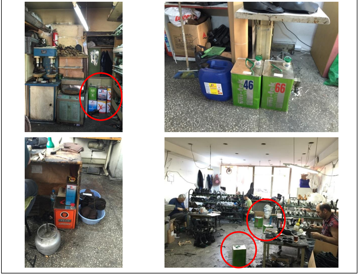
Resim 4.9 Tehlikeli Kimyasalların Uygunsuz Depolanması
