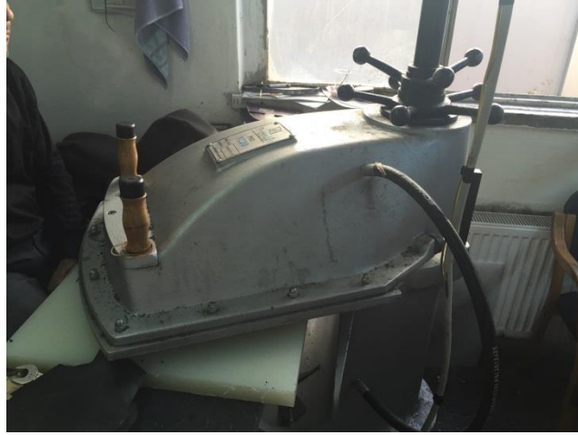
Resim 2.7 Döner Başlıklı Kesim Presi
