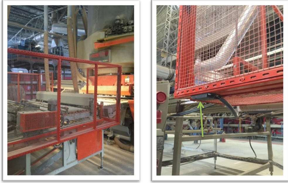
Resim 4.4. İyileştirme sonrası pres önü karo çeviricilerde mikro sensör
