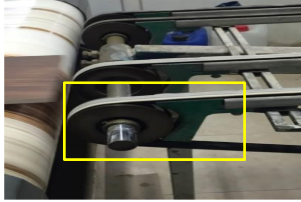
Resim 4.15. Bantın geometrisine uygun olarak torna ve freze ile üretilmiş mekanik koruyucular
