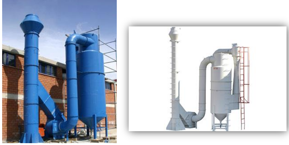
Resim 2.14. Yaş tip toz tutma sistemleri [20]
