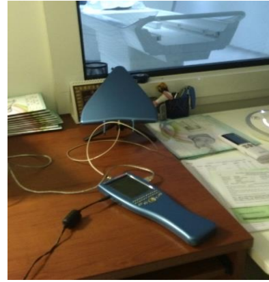
(a) Aaronia Spektran HF – 60105 [37] (b) İşyeri-E Cihazın Yalıtkan Ayakla Kullanılması
