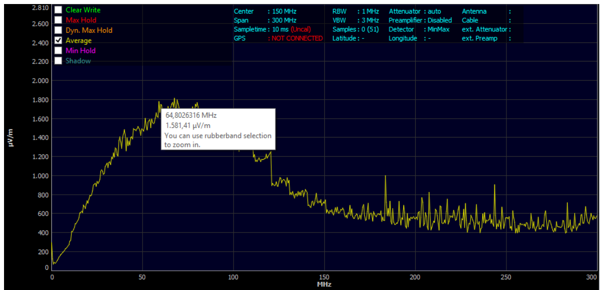
Şekil-4. İşyeri B - Elektrik Alan Ekran Görüntüsü
