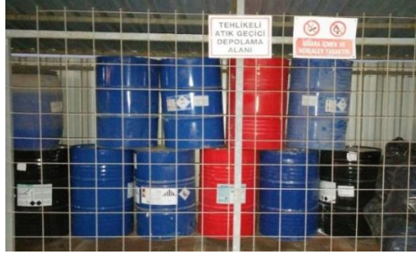
Resim 4.8. Patlama oluşturacak şekilde depolanan malzemeler
