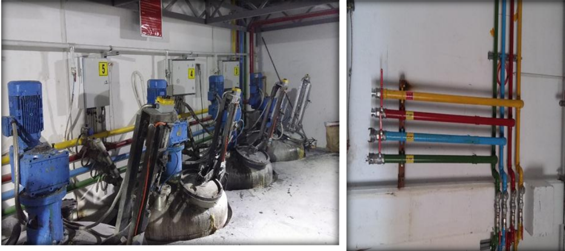
Resim 4.19. Kapalı sistem tutkal imalatı (solda), malzeme boruları (sağda)
