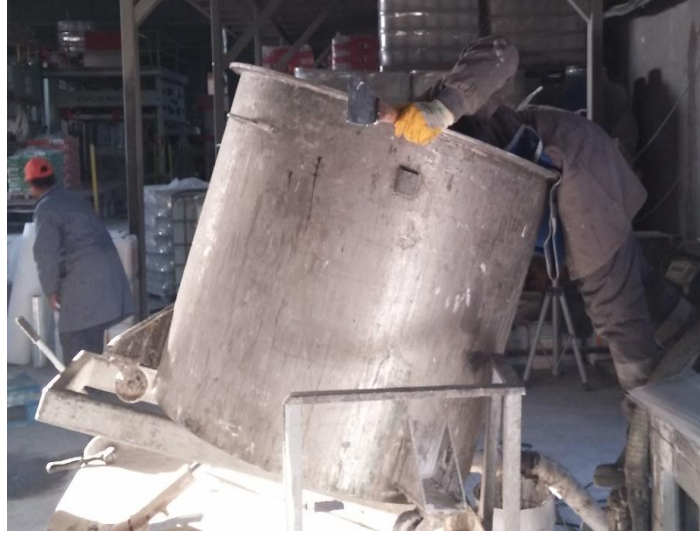
Resim 4.1. Kazanın artıklardan temizlenmesi
