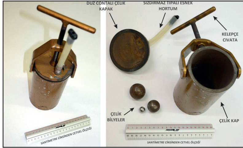
Şekil 2.9. Kömür numunelerinin toplanması için çelik bilyeli hava geçirmez çelik silindirik kap [85] .
