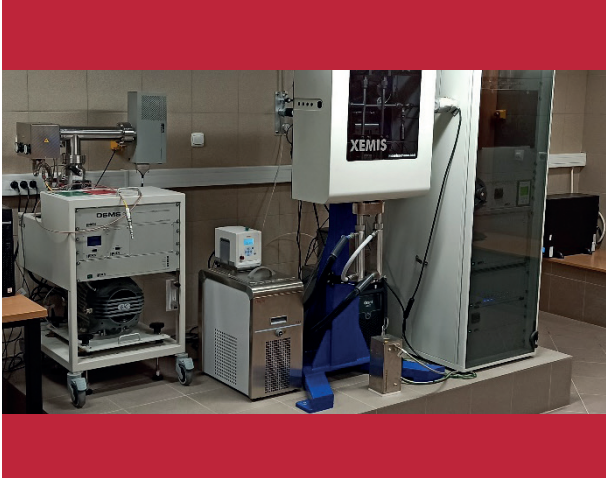
Şekil 2.15: AGH UST laboratuvarında kömür üzerindeki gazların sorpsiyonu ve desorpsiyonu için kullanılan XEMIS cihazı.
