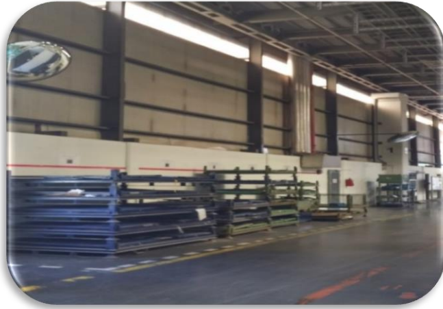
Şekil 4.16 Forklift trafiğinde tümsek ayna kullanımı
