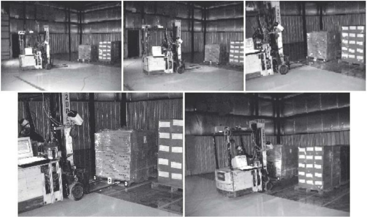
Şekil 2.6 Kamera sistemi aracılığıyla paletin forklifte yerleştirilmesi[17]
