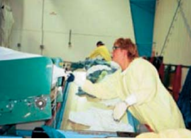
Şekil 1: Besleyici oluğu değiştirilmeden önce çalışanların uygun-suz pozisyonlarda çalışması gerekiyordu. Kaynak HSE, UK.
