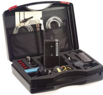
Şekil 3.2. SKC 224-52tx Sidekick tipi örnekleme pompası [45].
