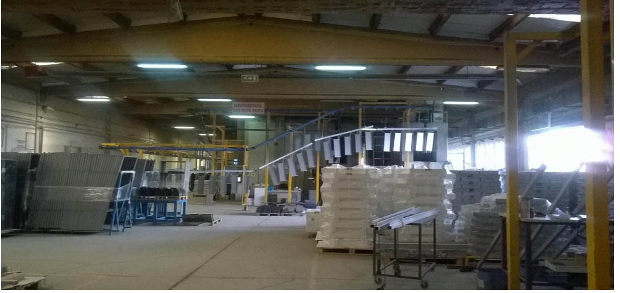
Resim 4.3. İşyeri C Elektrostatik Toz Boyama Hattı
