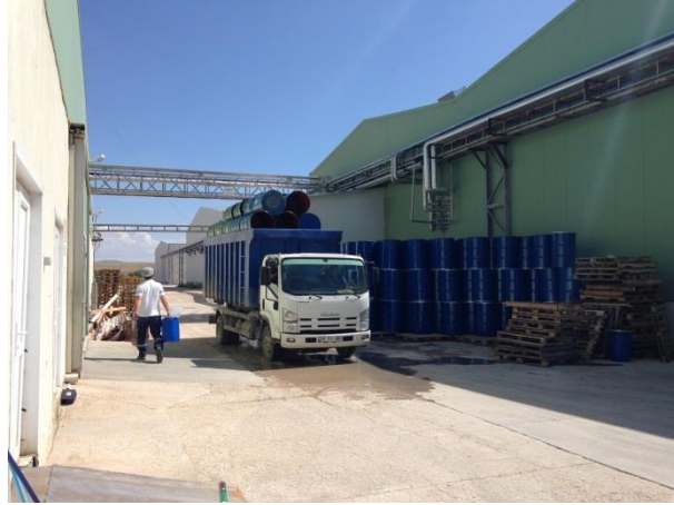
Resim 4. 1. İşaretlenmemiş Yürüyüş, Geçiş ve Araç Yolları
