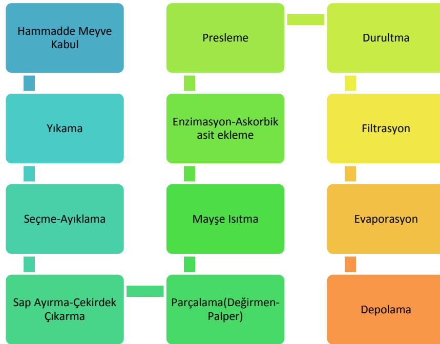
Şekil 2.1. Meyve Suyu Üretimi Akış Şeması [6]
