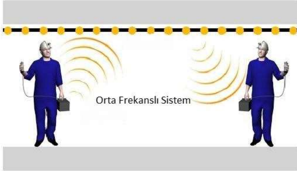
Şekil 2.15. İki orta frekanslı telsiz arasındaki bağlantı [18]
