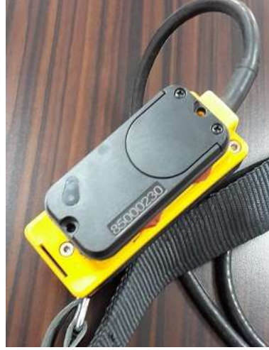
Resim 4.15. Madenci lambasına monte edilen etiket
