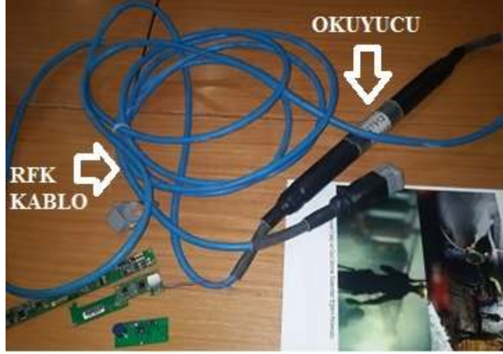
Resim 4.9. RF kablosu ve içerisinde yerleştirilmiş olan okuyucu
