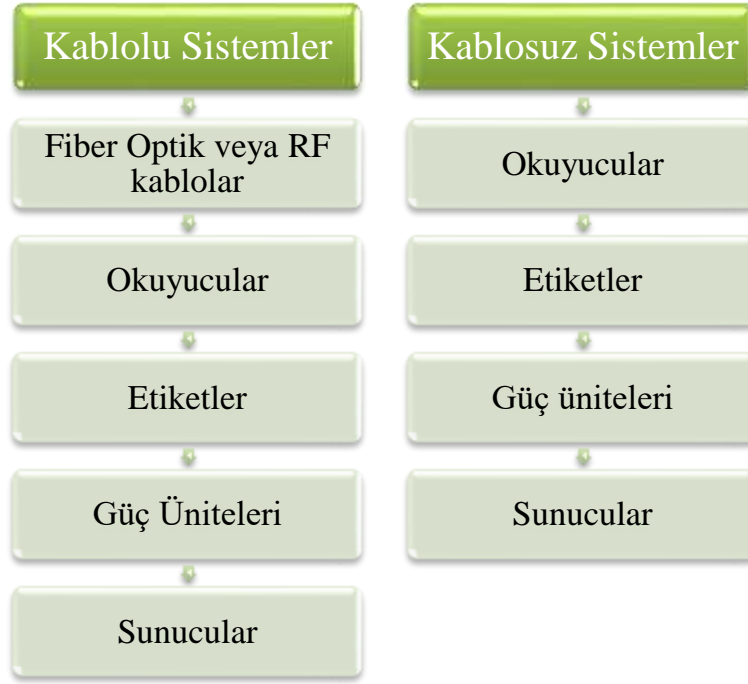
Şekil 2.18. Takip sistemlerinde kullanılan ekipmanlar
