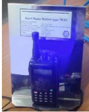
Resim 4.8. Yeraltı haberleşmesinde kullanılan telsiz
