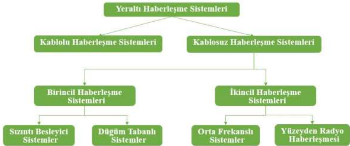
Şekil 2.1. Yeraltı madenlerinde kullanılan haberleşme sistemleri [13]
