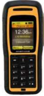
Resim 4.6. Yeraltı kullanılan kablosuz maden telefonu
