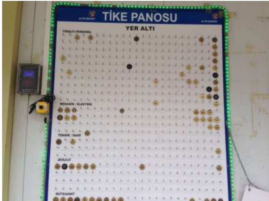
Resim 2.2. Yeraltı madeninde bulunan tike tahtası
