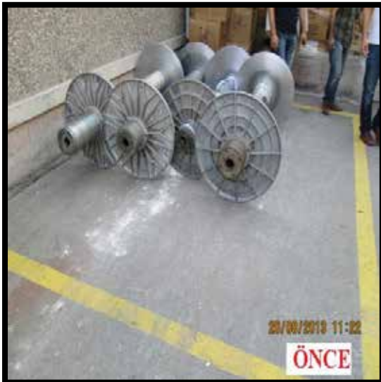
Şekil 4.21 - Teftişlerden sonra levent önlerine konulan takozu gösteren fotoğraflar
