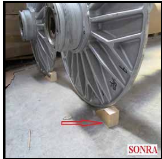
Şekil 4.21 - Teftişlerden sonra levent önlerine konulan takozu gösteren fotoğraflar
