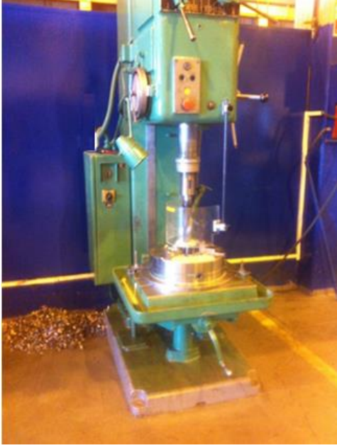
Resim 3.11. Radyal matkap ile delme işlemi
