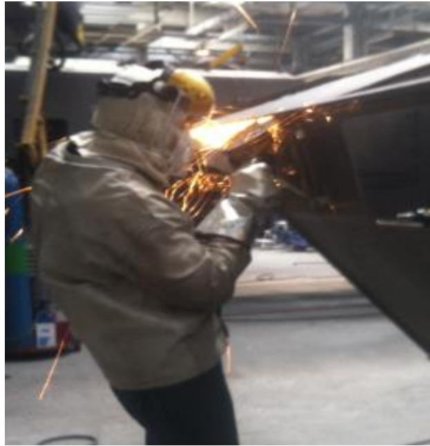
Resim 3.18. Çapak alma işlemi
