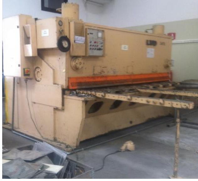
Resim 3.8. Giyotin makas ile kesim işlemi
