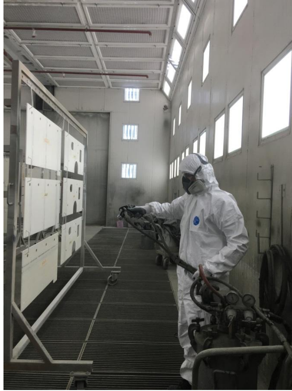
Resim 3.23. Hava püskürtme işlemi
