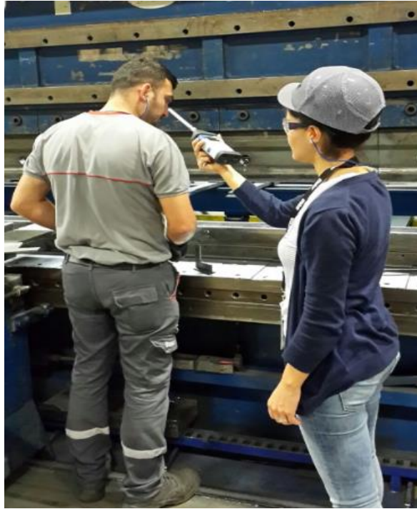
Resim 3.2. El tipi ses seviye ölçer (Svantek 947) kullanımı
