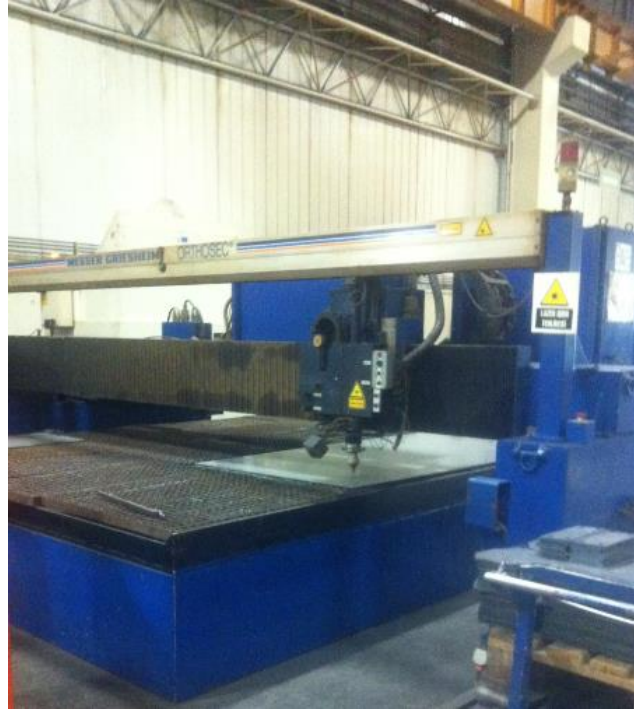
Resim 3.9. Lazer kesim işlemi
