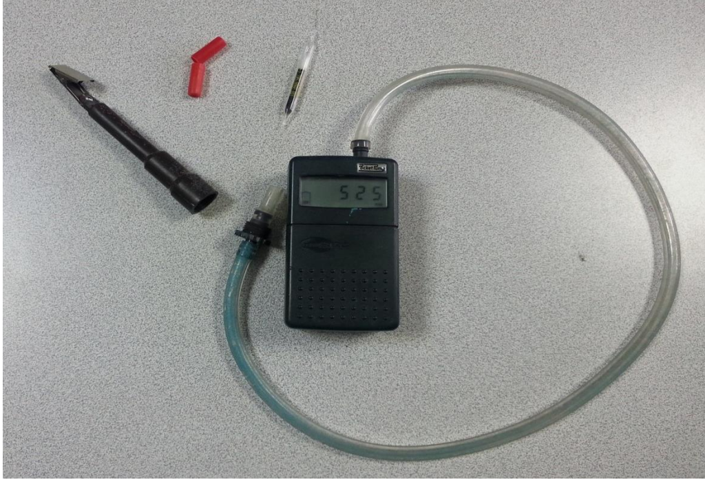
Resim 3.2. Kişisel örnekleme pompası, başlık ve örnek tüp
