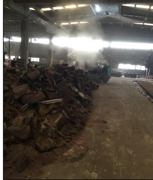
Resim 4.4 Klasik yöntem ile dökümden kumu ayırma
