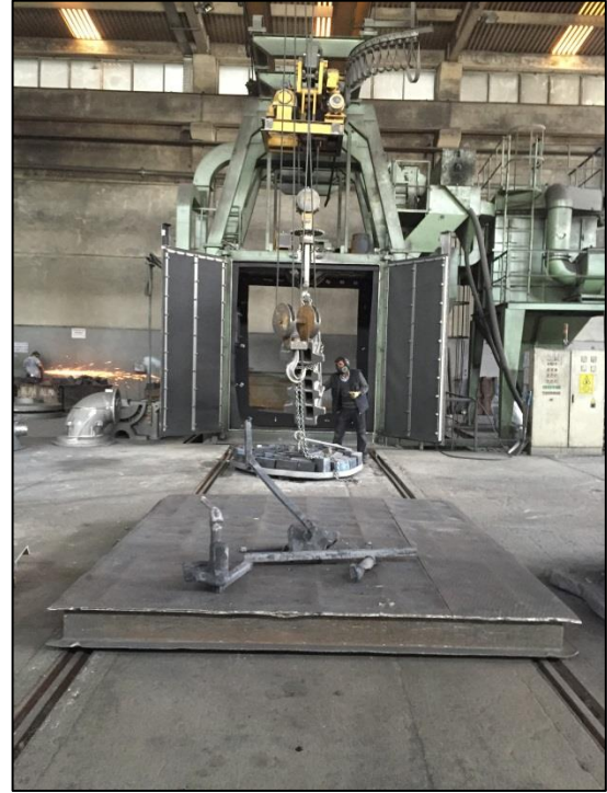
Resim 2.9 Çelik kuşlama makinesi
