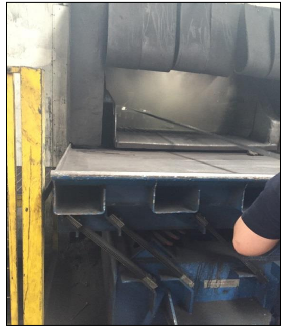
Resim A3 Solunabilir toz ve silis maruziyetinin aza indirilmesi için kullanılan kapalı sarsak sistemi örnekleri
