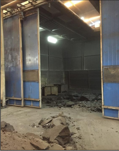
Resim A3 Solunabilir toz ve silis maruziyetinin aza indirilmesi için kullanılan kapalı sarsak sistemi örnekleri
