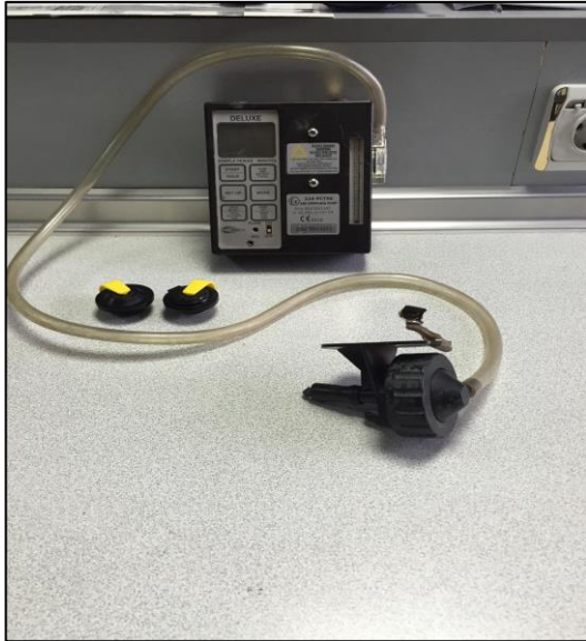
Resim 3.4 Ağır metal ölçümünde Kullanılan deluxe tip pompa
