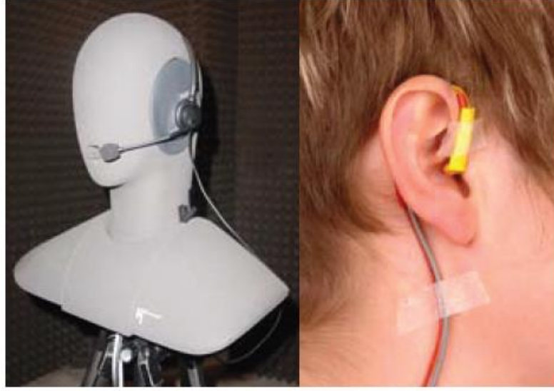
Şekil 15. HATS ve MIRE tekniği kullanılarak kulakta gürültü ölçümü
