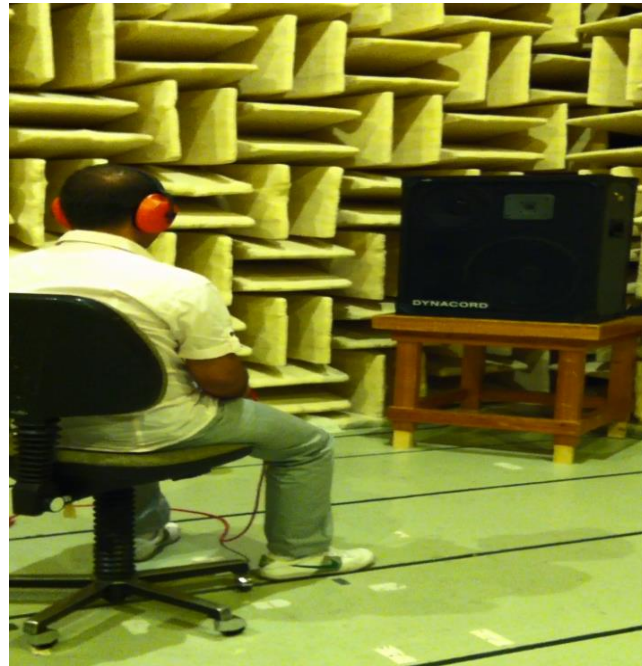
Şekil 35. Yarı yankılı odada kulak koruyucu testi
