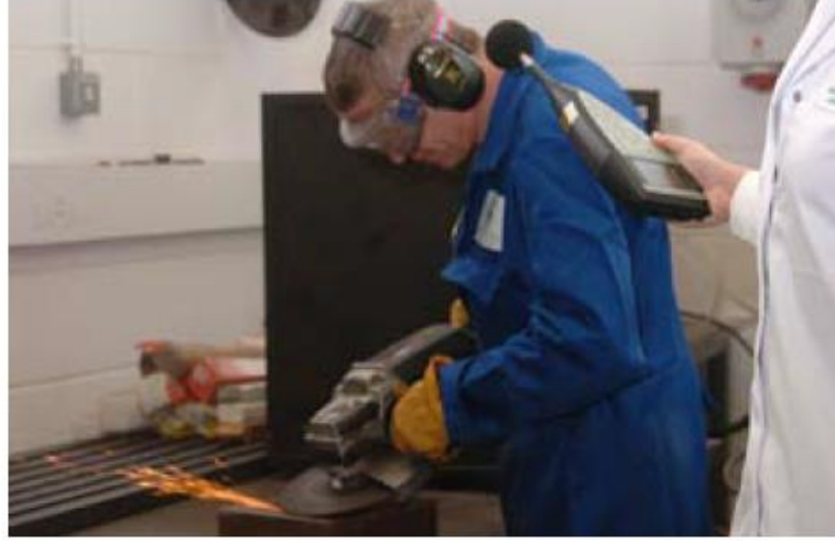
Şekil 13. Ses seviye ölçerle gürültü ölçümünün yapılışı
