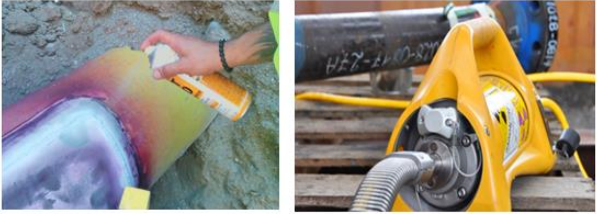
Resim 4.5. Tahribatsız muayene yöntemleri
