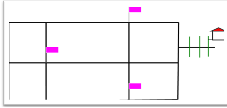
Şekil 2.4. Mesh + Dead - End şebekesinin şematik gösterimi [14]
