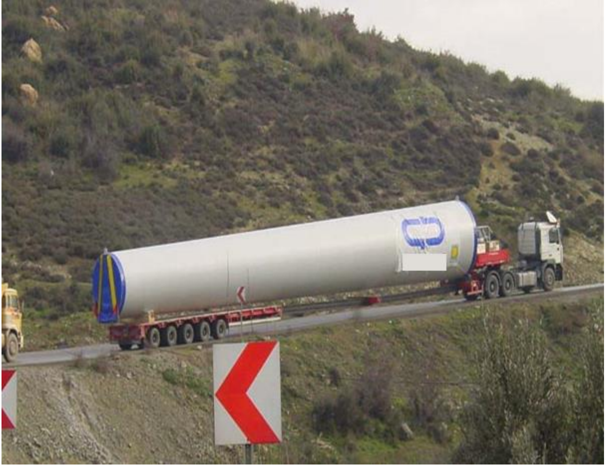
Şekil 2.9. Türbin parçalarının türbin sahasına nakliyesi
