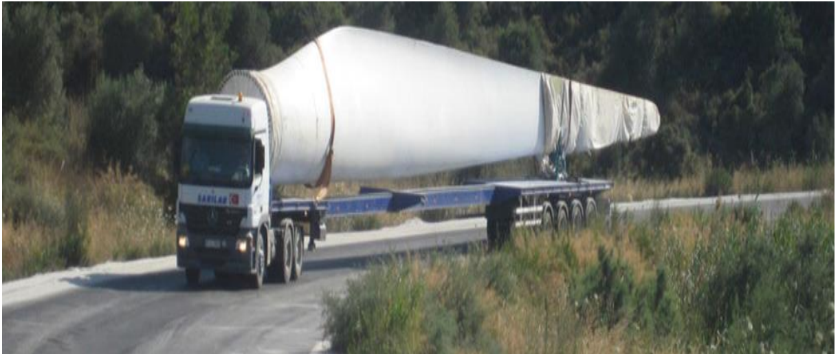
Şekil 2.10. Türbin parçalarının türbin sahasına nakliyesi
