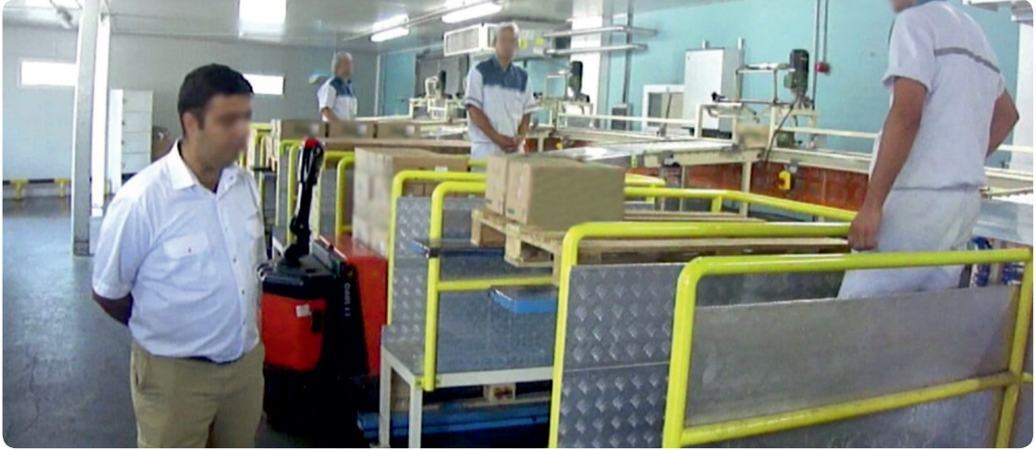
Şekil 4: İyi uygulama örneği: Çalışanların eğilerek yük kaldırmasının ve taşımalarının engellenmesi için yapılmış hidrolik sistemi ve konveyörler
