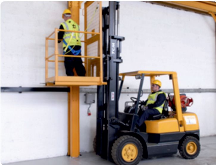
Şekil 10: Çalışanların forklift ile güvenli kaldırılması
