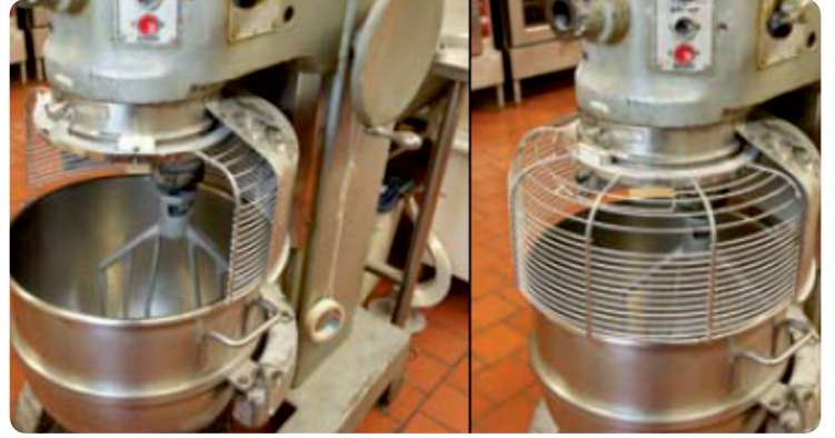
Şekil 16: Koruyucu donanım kapanmadan çalışmayan bir makine
