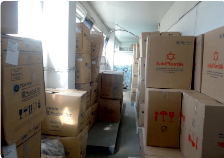
Şekil 7: Geçiş alanı dar, yangın önlemi alınmamış depo
