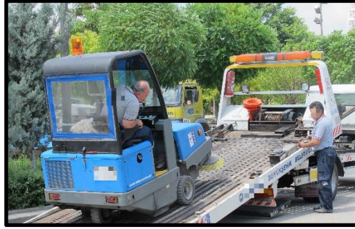
Resim 4.36. Süpürme makinesinin araca yüklenmesi
