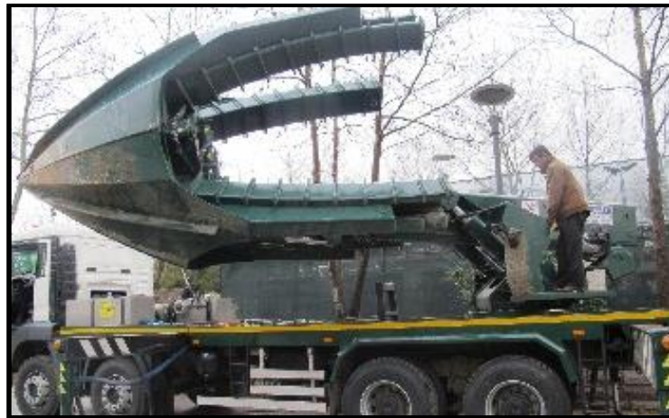
Resim 4.22. Ağaç dikme ve sökme makinesi
