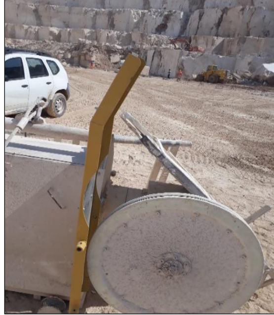
Resim 3.2- Mermer ocağında soket fırlamasına karşı yapılan seyyar siper ve kasnak muhafazası uygulamaları
