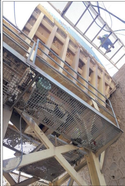
Resim 3.3- Mermer ocağında kademeden ve kırma eleme tesisinde yüksekte düşmeye karşı alınan önlemlere dair örnekler
