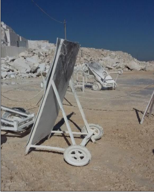
Resim 3.2- Mermer ocağında soket fırlamasına karşı yapılan seyyar siper ve kasnak muhafazası uygulamaları
