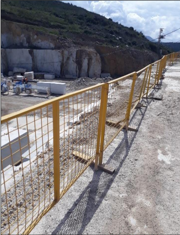
Resim 3.3- Mermer ocağında kademeden ve kırma eleme tesisinde yüksekte düşmeye karşı alınan önlemlere dair örnekler
