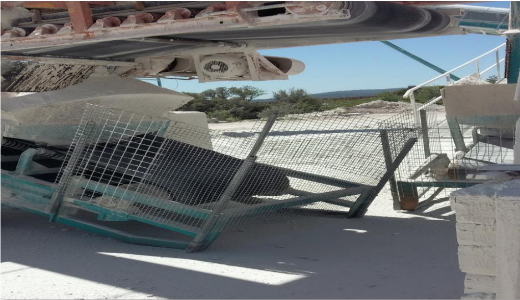
Resim 3.1- Taş ocağında mekanik temas riskine karşı açıkta dönen aksamaların kapatılması
