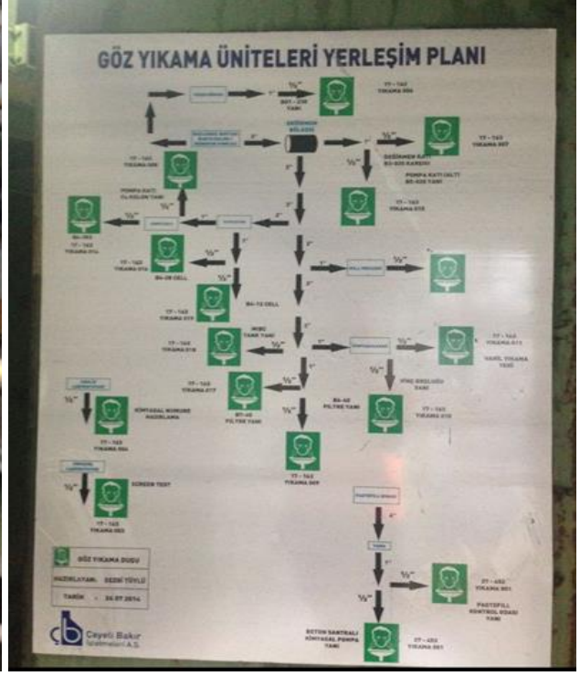
Resim 2.10. Göz yıkama üniteleri yerleşim planı
