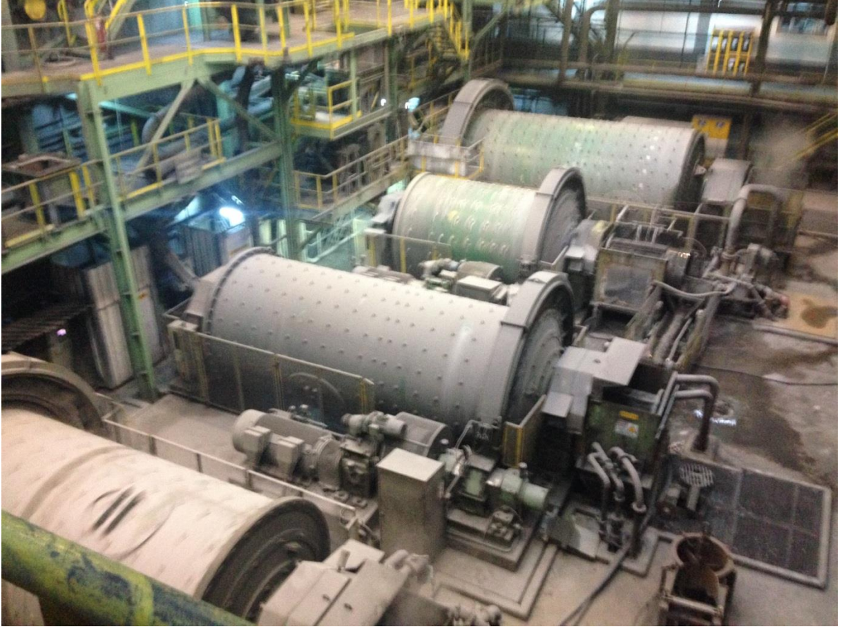
Resim 2.1. Öğütme ünitesinde bulunan değirmenler
