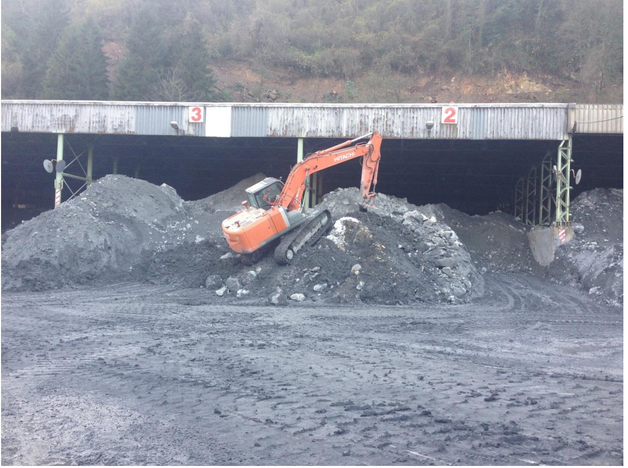
Resim 2.4. Stok sahasında cevher harmanlanması
