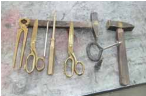
4.13 Patlayıcı Madde Ambalajı Açmakta Kullanılan Pirinç Aletler
