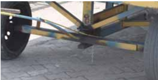
4.17 Statik Yüke Karşı Topraklanmış Patlayıcı Madde Taşıma Aracı
