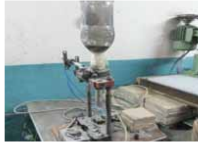
4.51 Barut Haznesinin Çalışma Ortamı İçinde Bulunduğu Kötü Örnek
