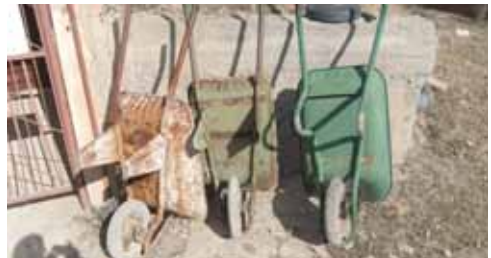
4.18 Uygun Olmayan Patlayıcı Madde Taşıma Araçları
