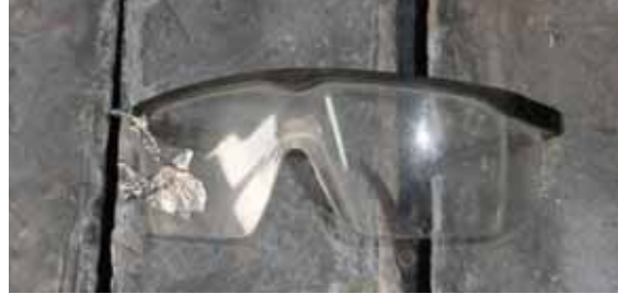
4.10 Üzerine Kurşun Sıçramış Koruyucu Gözlük
