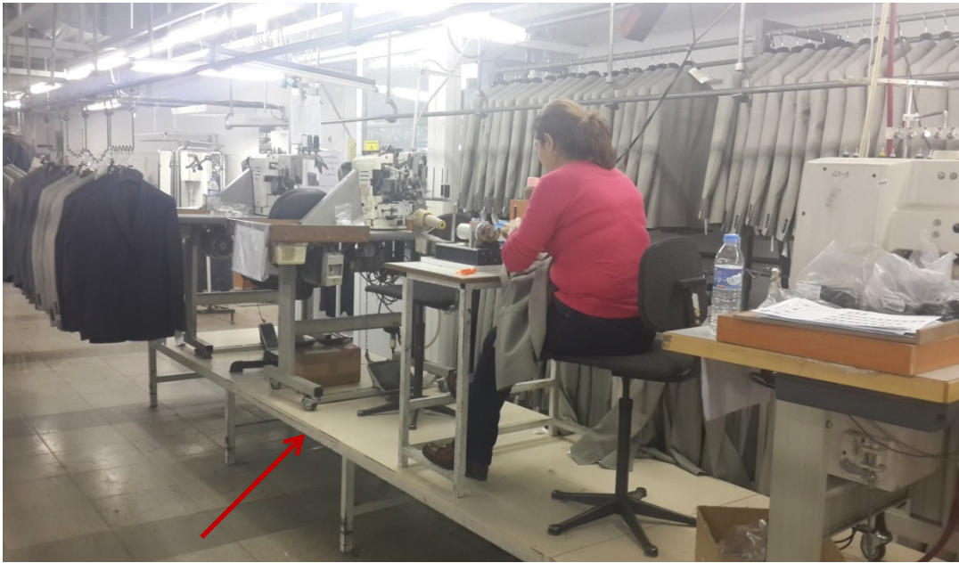
Resim 4.8. Çalışma istasyonunun yükseltilmesi
