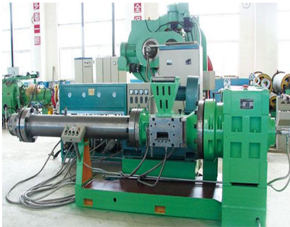
Şekil 18: Soğuk besleme kauçuk ekstruder
