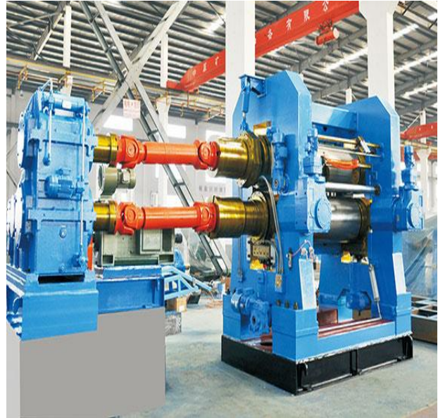
Şekil 13: Kauçuk kalender makinesi
