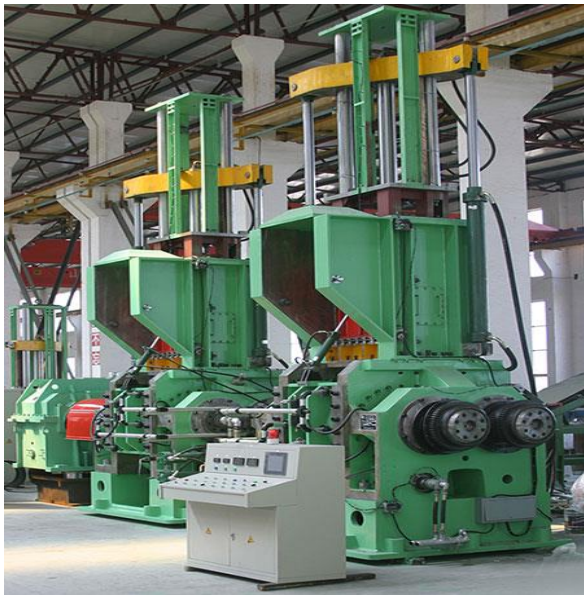
Şekil 6: Banbury mikser makinesi
