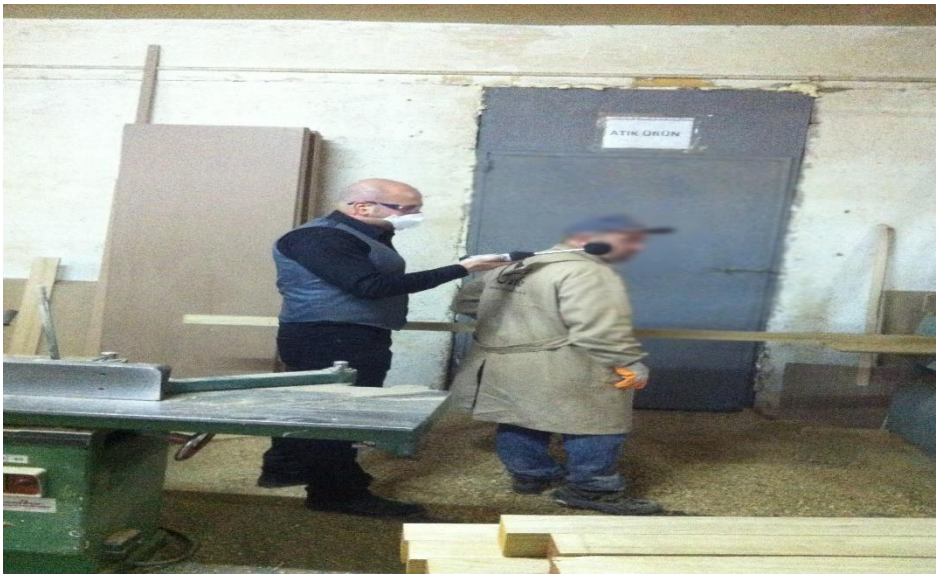
Şekil 3.8. El tipi ses seviye ölçer kullanımı
