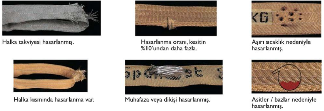
Şekil 23. Hasara uğramış kullanım dışı bırakılması gereken sapan numuneleri [16]
