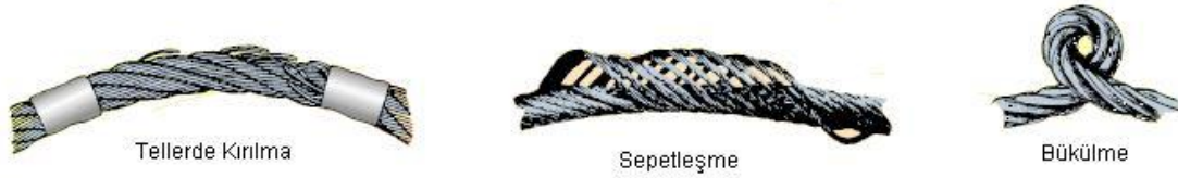
Şekil 17. Halatlarda meydana gelen bazı hasarlar [13]
