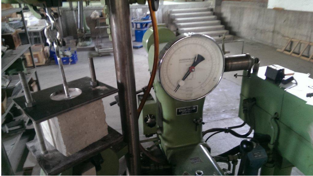
Resim 2.11 C20 betonu ile aderans kuvvetinin ölçümü
