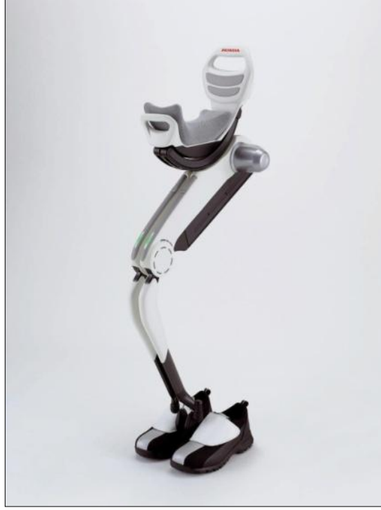
Şekil 6. Honda Motor Şirketi Tarafından Geliştirilen Yürüme Destek Aracı (Honda, 2014)
