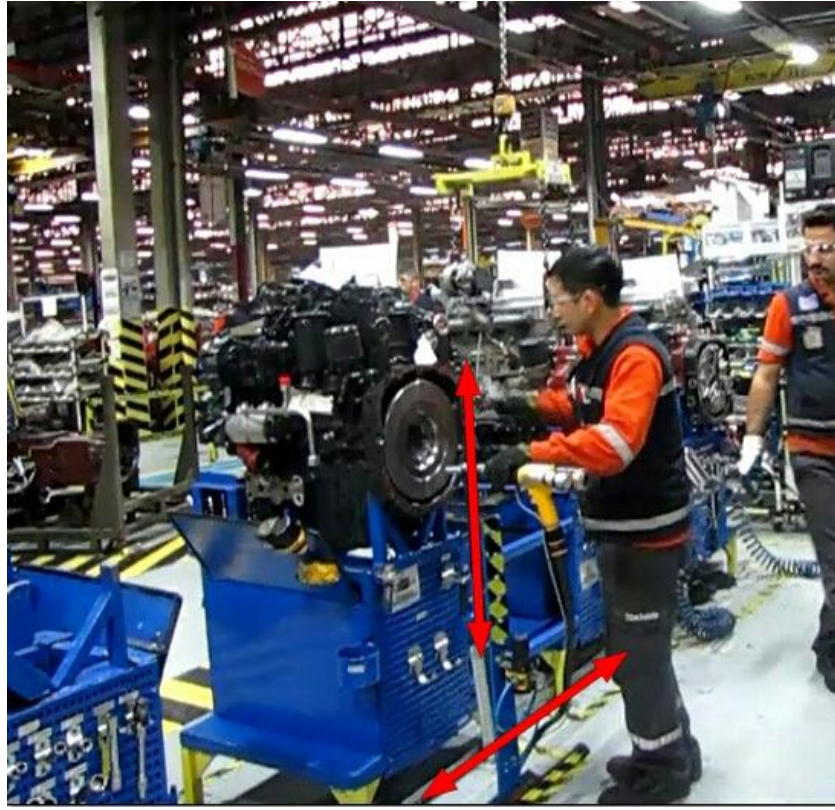
Şekil 29. Volan Montajı İyileştirme Sonrası İstasyonunun Görünümü
