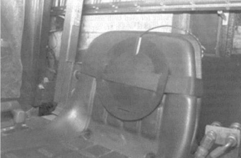
Resim 13. Tüm Vücut Titreşim Ölçer Diskinin Sırt Ölçümlerinde Kullanılması
