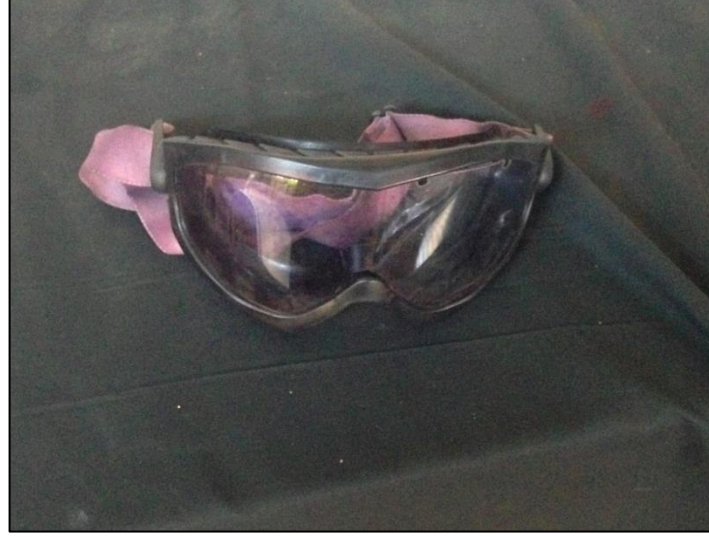
Resim 4.10. Toz boya tartımında kullanılan kontamine koruyucu gözlük
