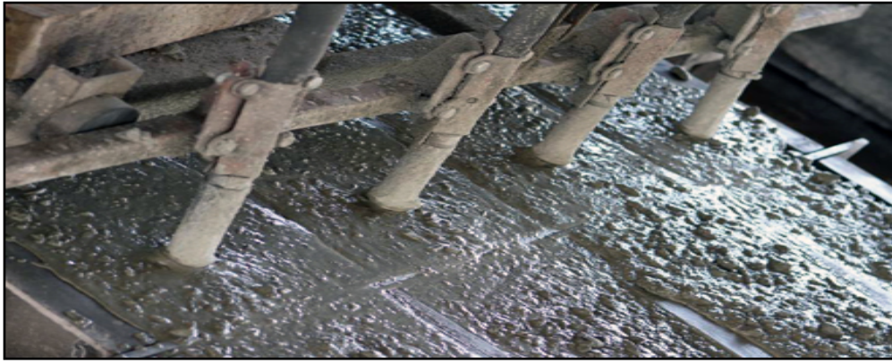
Resim 2.16. Sektördeki Titreşim Kaynakları (Travers Vibrasyon Tezgahı)
