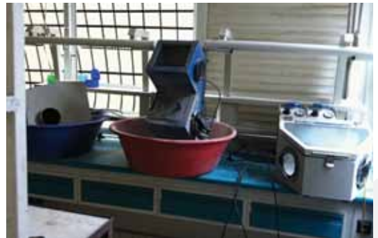
Şekil 37. Balkonlara Konmuş Toz Çekme Sistemi Olmayan Kumlama Cihazları
