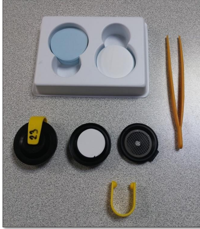
Resim 3.2. PVC Filtre ve filtre kaseti
