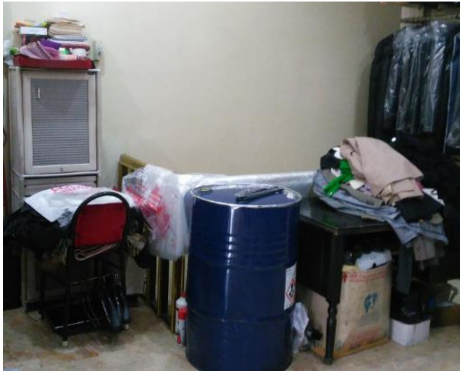
Resim 4.5. PERC Tankının Atölyede Etiketsiz ve Uygunsuz Bir Durumda Tutulması
