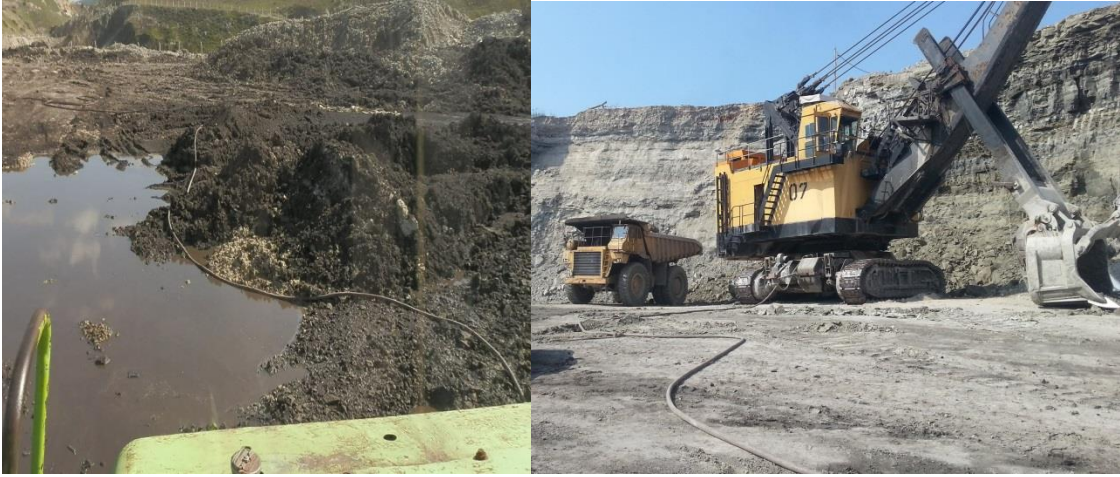
Resim 2.22. Elektrik çarpması nedenleri
