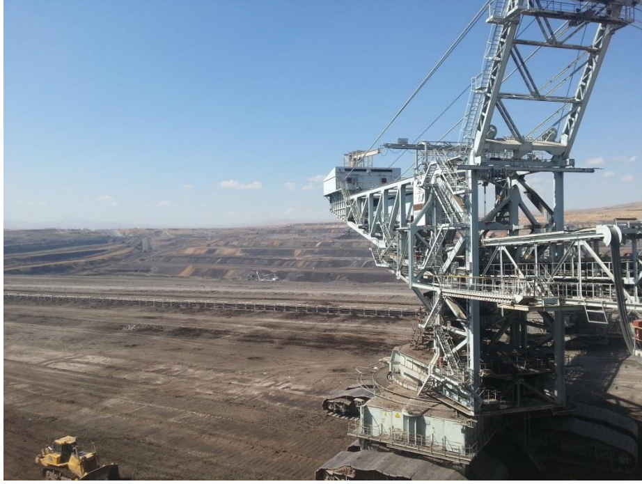
Resim 2.5. Döner kepçeli ekskavatör ve bant konveyör kombinasyonu
