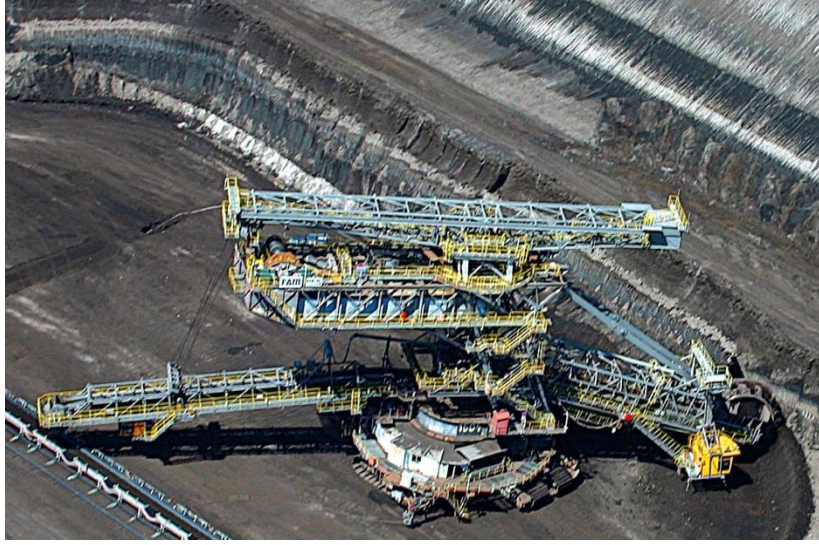
Resim 2.2. Sürekli üretim sistemine örnek [10]
