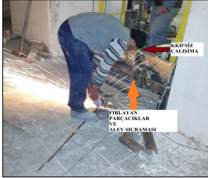
Resim 4.6. Spiral kesme makinesi ile metal malzeme kesimi
