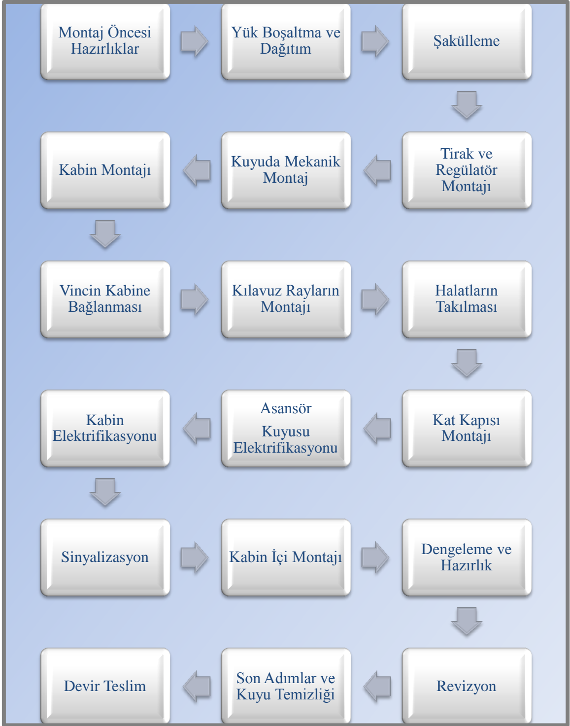
Şekil 2.2. Asansör montajı akış şeması
