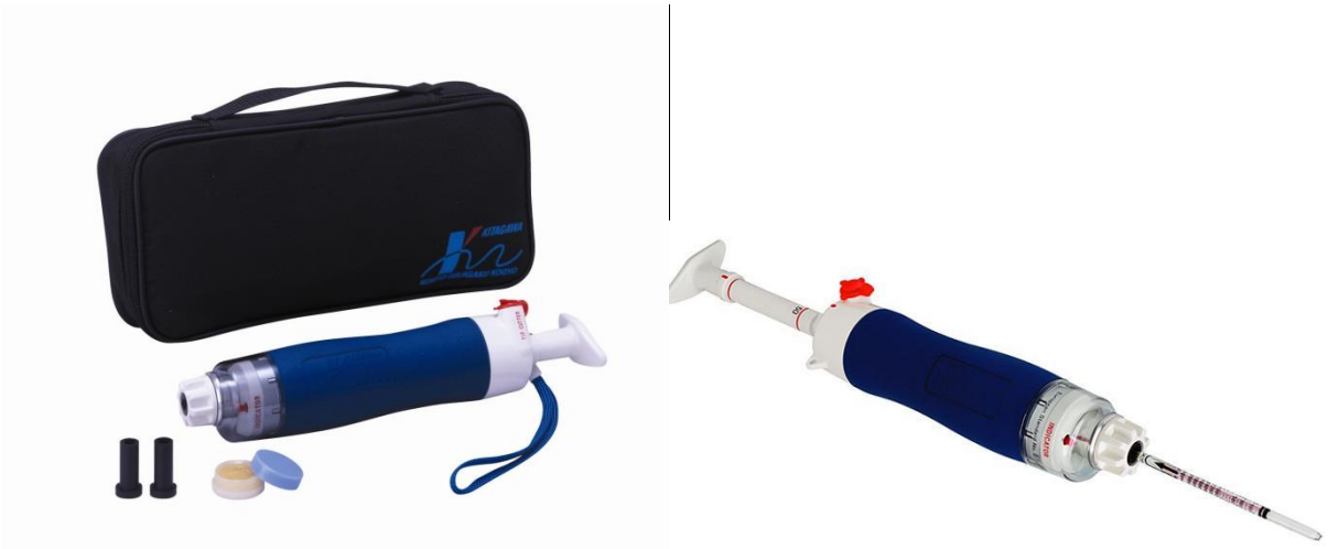
Resim 9. Kitagawa anlık gaz pompa ve detektörü
