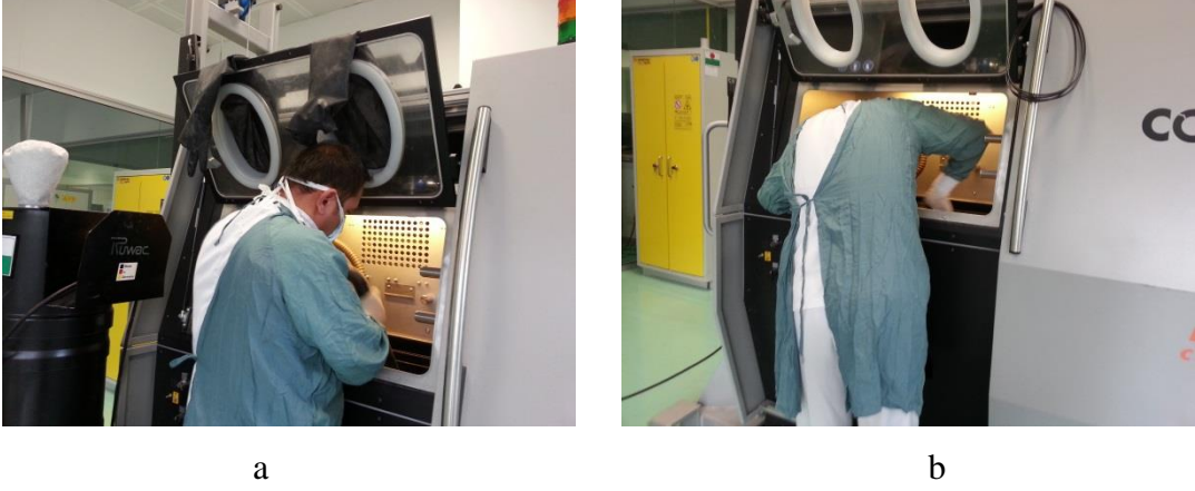
Resim 3.10. Sistemin Elektrik Süpürgesi (a) ve Nemli Bez (b) ile Temizlenmesi
