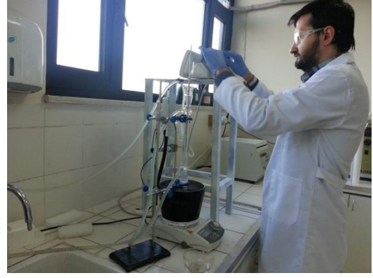
Resim 3.4. Hazırlanan Solüsyonun Yağ Banyosuna Yerleştirilmesi
