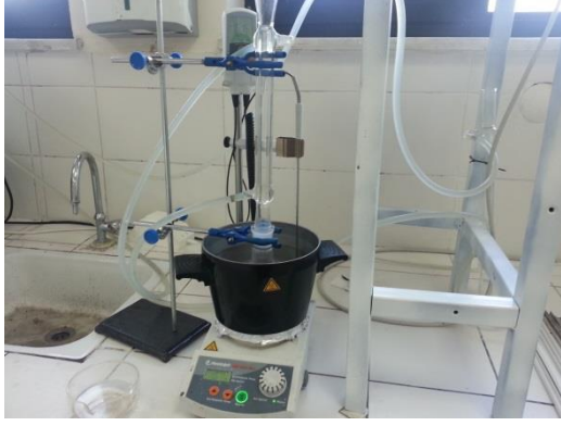
Resim 3.4. Hazırlanan Solüsyonun Yağ Banyosuna Yerleştirilmesi
