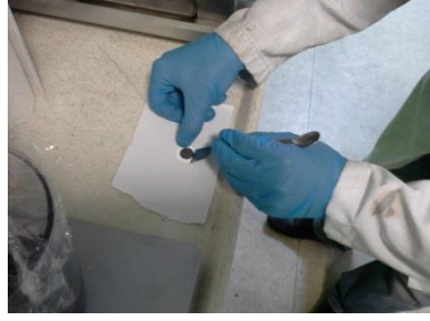
Resim 3.12. Elde Edilen Garfenin Süzgeç Kâğıdından Ayrılması
