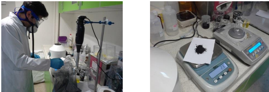
Resim 3.11. Ana Malzeme Olan Grafitin Tartılması
