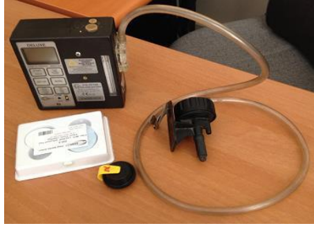
Resim 3.5. Kişisel hava örnekleme pompası, siklon başlık, MCE membran filtre ve filtre kaseti
