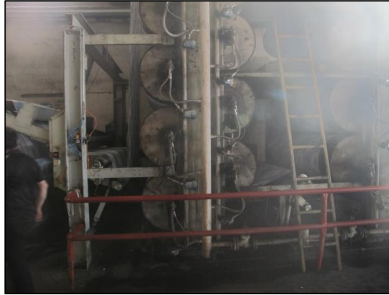
Resim 4.53. Kızgın yağ ile fiksaj yapan fiksaj makinesi
