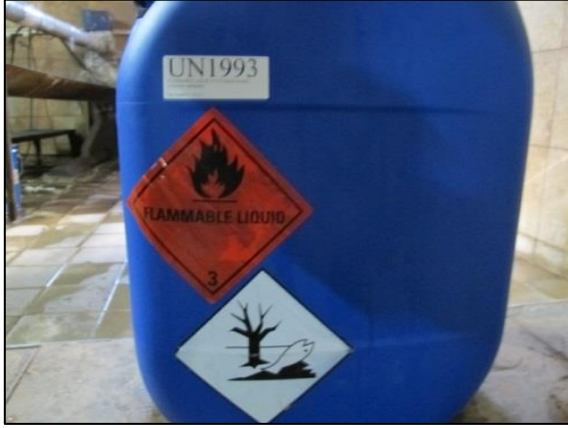
Resim 4.45. Alevlenebilir maddelerin çalışma alanında muhafaza edilmesi
