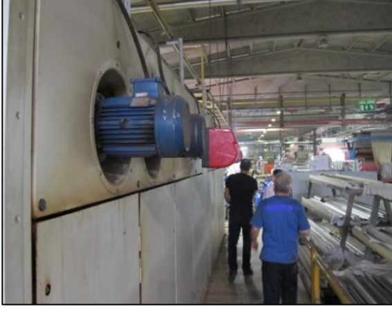
Resim 4.57. Geçiş yolu üzerinde makineye ait çıkıntılı kısımlar bulunması
