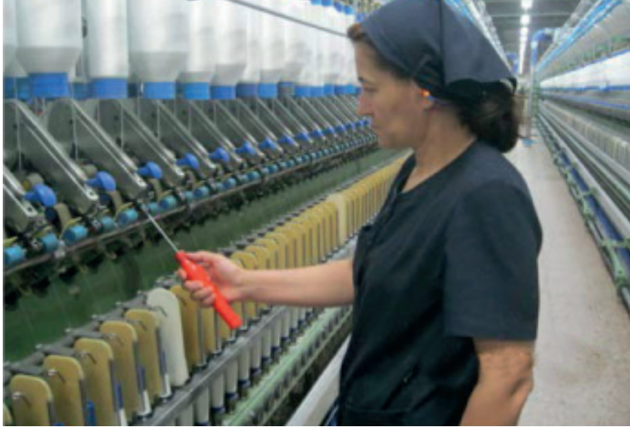
Resim 2. Tozun yayılımını önleme. Akülü hav tabancası ile üretim esnasında ortaya çıkan havların toplanması.
