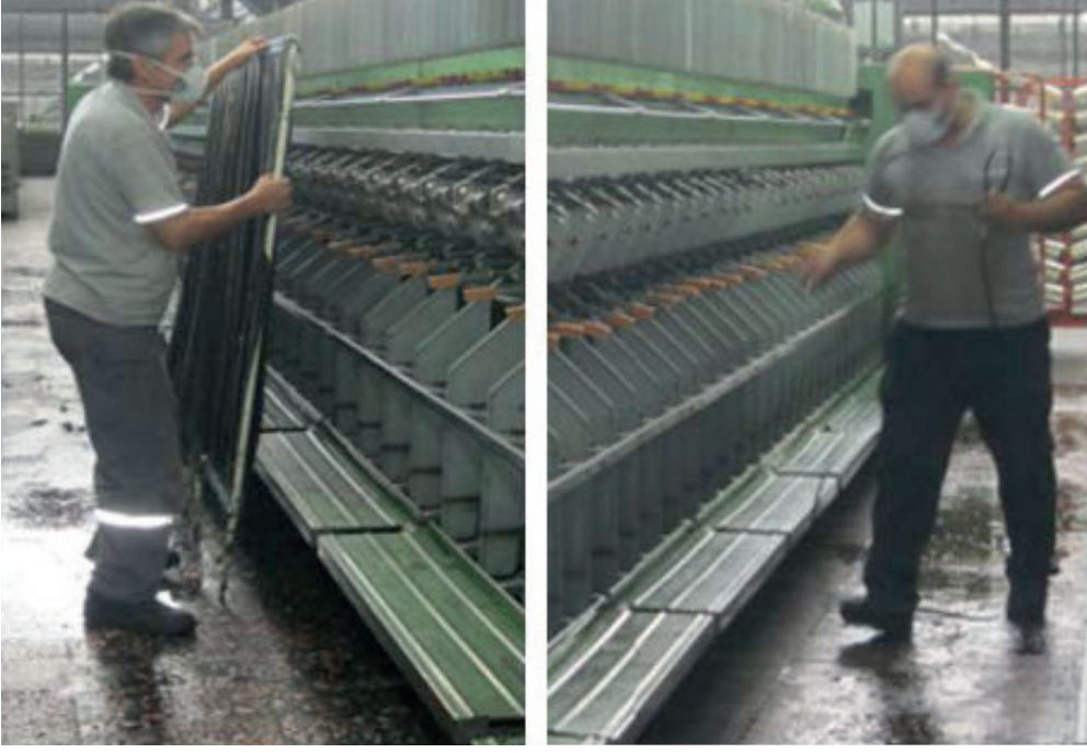
Resim 8. Temizlik esnasında paravan kullanılması ve KKD kullanımı ile kişisel koruma sağlanması.
