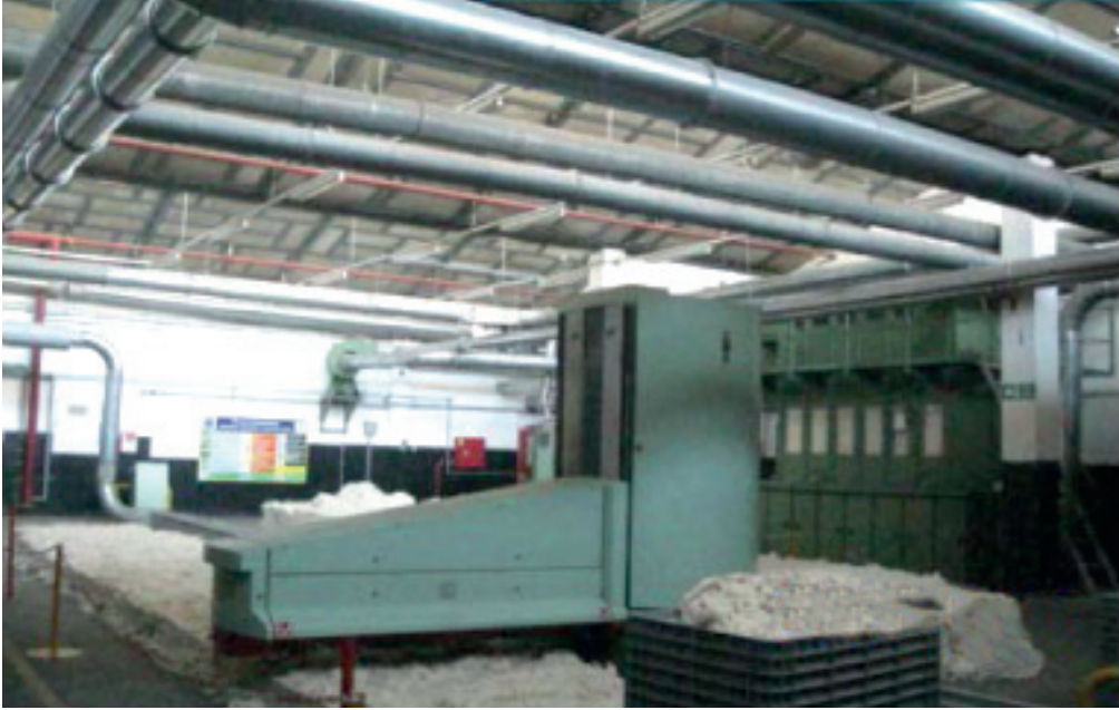
Resim 5. Tozun yayılımını önleme. Makinalar üzerinde yer alan toz emme kanalları ve makinalar arası transferin boru hatları ile gerçekleştirilmesi.
