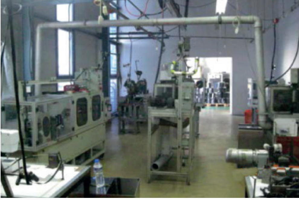
Resim 12. Toz çıkaran işlemlerin makine emişlerinin hatta bağlanarak tozların haznelerde toplanması.
