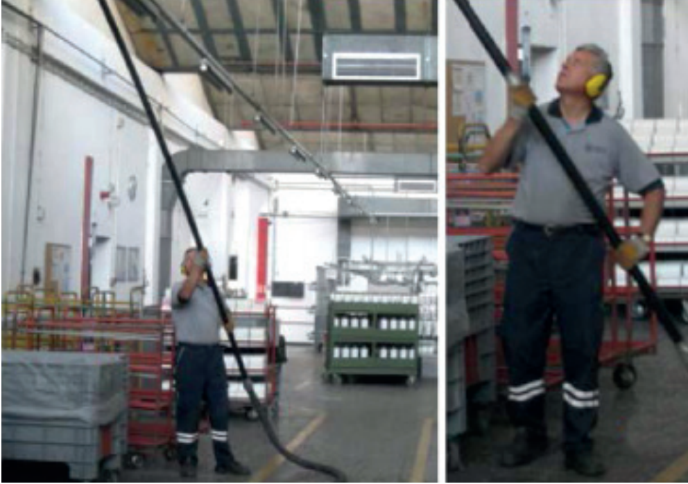
Resim 9. Tozun yayılımını önleme. Vakumlu sistemlerle periyodik hav temizliği yapılarak birikmenin ve yayılımın önlenmesi.
