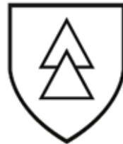
Şekil 28: Gerilim altında çalışma eldiven TS EN 60903 piktogramı (TS EN 60903 Eldivenler - Yalıtkan malzemeden - Gerilim altında çalışma, 2005)
