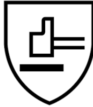
Şekil 16: Mekanik risklere karşı koruyucu eldiven piktogramı (TS EN 388 + A1 Mekanik risklere karşı koruyucu eldivenler, 2018)
