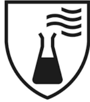
Şekil 18: Kimyasal risklere karşı koruyucu eldiven TS EN ISO 374-1 piktogramı (TS EN ISO 374-1/A1 Tehlikeli Kimyasallara ve Mikroorganizmalara Karşı Koruyucu Eldivenler - Bölüm 1: Kimyasal Riskler İçin Terimler ve Performans Kuralları - Ek 1, 2018)
