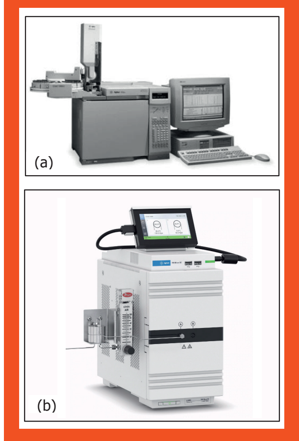
Şekil 5.3 Bir (a) sabit gaz kromatograf ve (b) Mikro GC (www.agilent.com).
