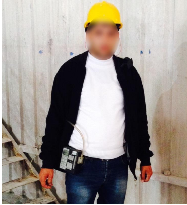
Şekil 3.5. SKC toz pompası ve siklon başlık konumu
