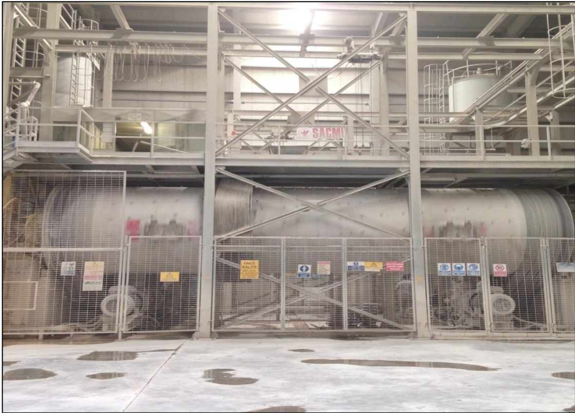
Şekil 2.4. Sürekli çalışan öğütme değirmeni
