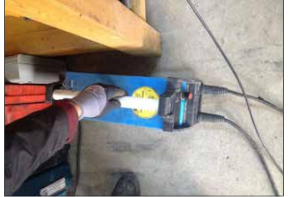
Şekil 5- Elektrikle Temas Riskine Karşın İzolesiz Kaynak Makinesinin İzoleli Olan Tiple Değiştirilmesi
