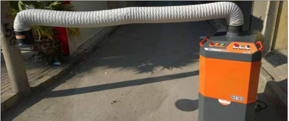
Şekil 6- Kaynak Yapılan Bölümde Lokal Havalandırma Sağlamak Üzere Alınmış Exproof Özellikteki Seyyar Havalandırma Cihazı
