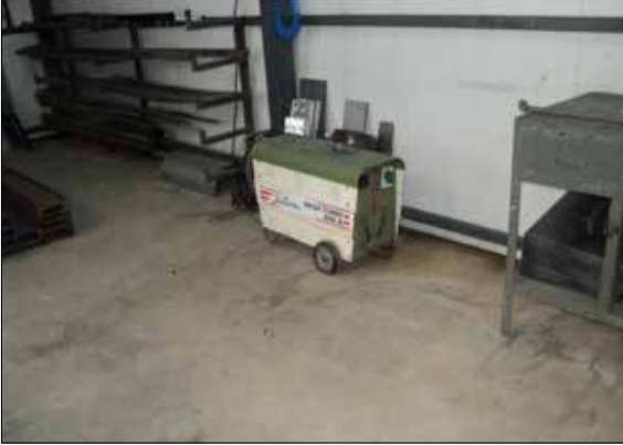
Şekil 5- Elektrikle Temas Riskine Karşın İzolesiz Kaynak Makinesinin İzoleli Olan Tiple Değiştirilmesi
