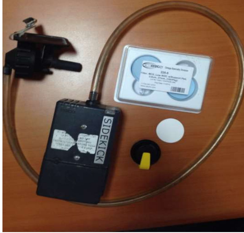
Resim 3.1. Kişisel Hava Örneklemeye Pompası, Siklon Başlık, MCE Filtre ve Filtre Kaseti
