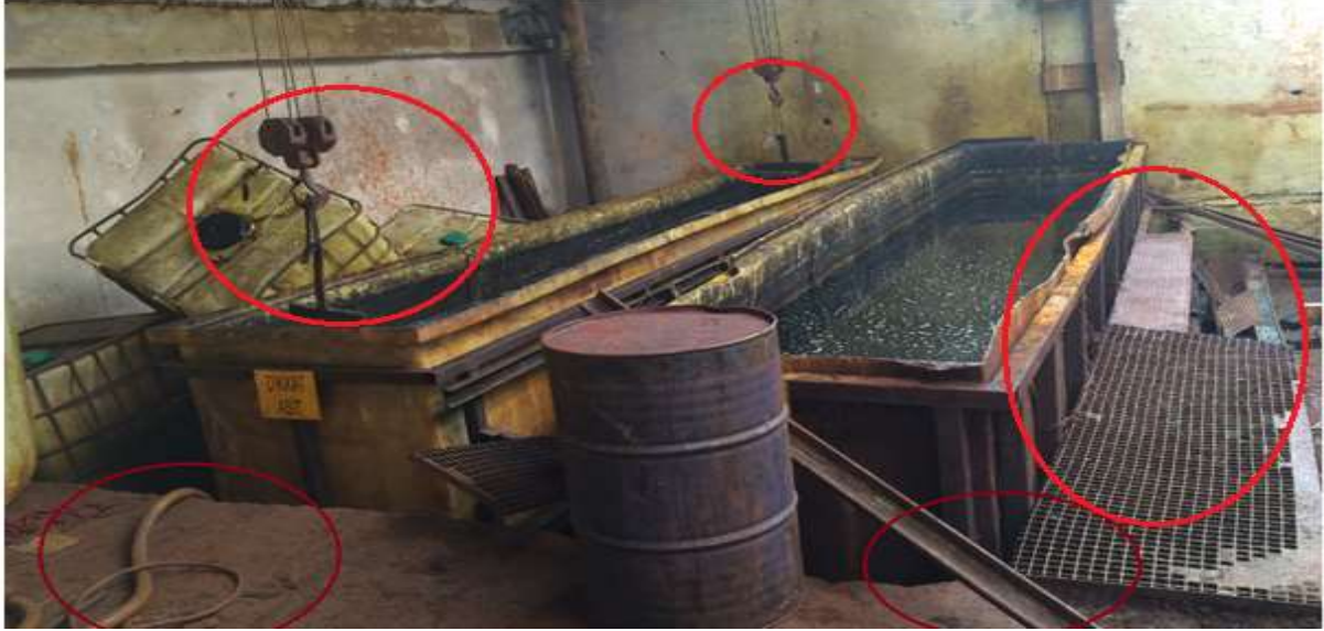
Resim 4.4. Yıpranmış Vinç Askısı, Sağlam Olmayan Kenar Platform ve Düzensiz Çalışma Ortamı
