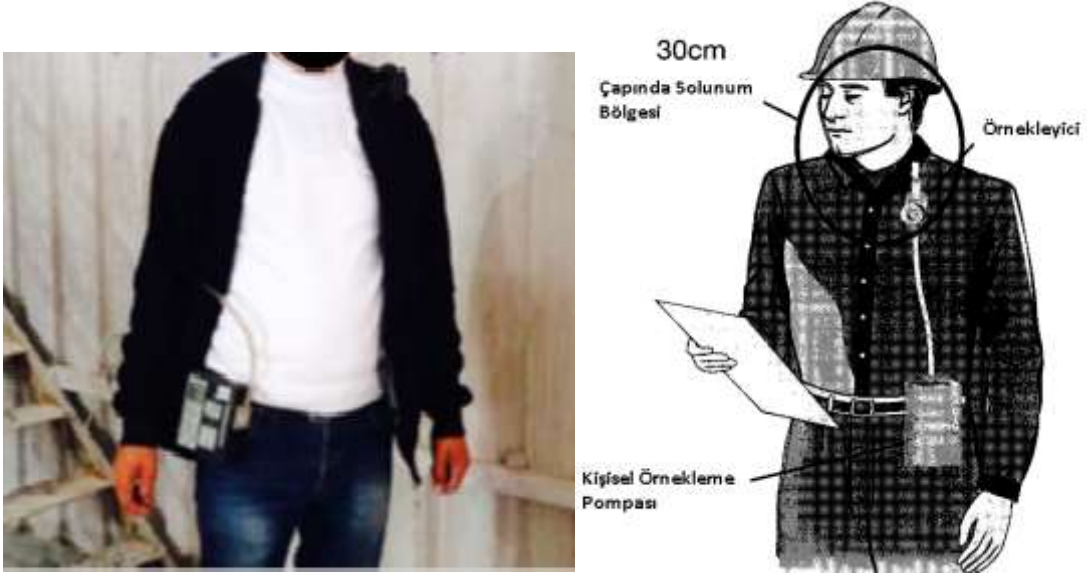
Resim 3.2. Ağır Metal Numune Alma Pompası ve Siklon Başlık Konumu
