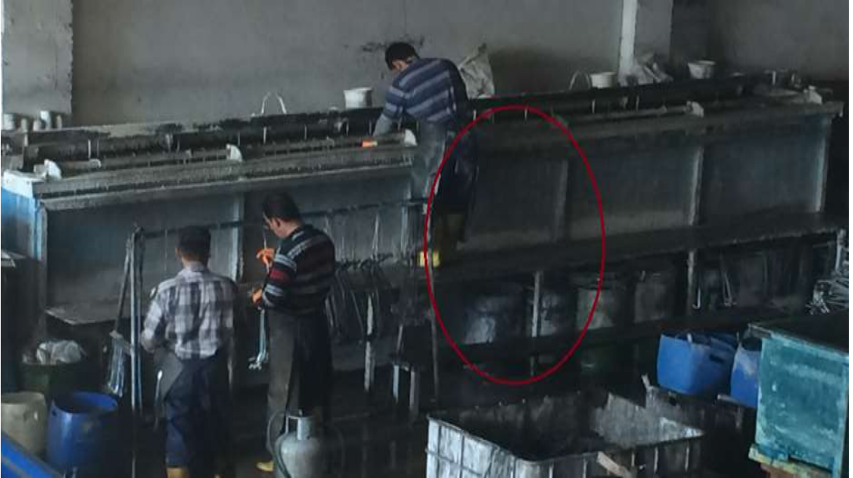
Resim 4.1. Korkuluk Bulunmayan Platformda Çalışılması
