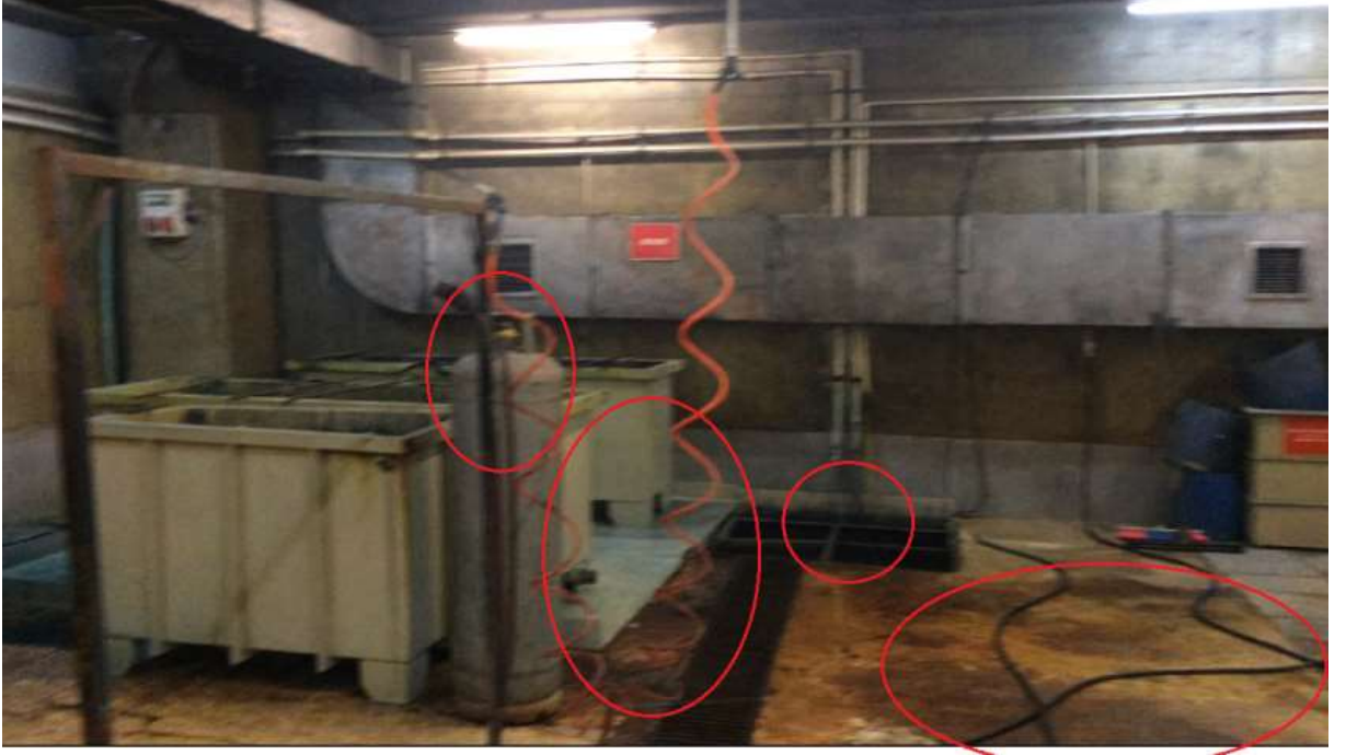
Resim 4.2. Kablolar Tarafından Engellenmiş ve Boşluk Olan Çalışma Zemini
