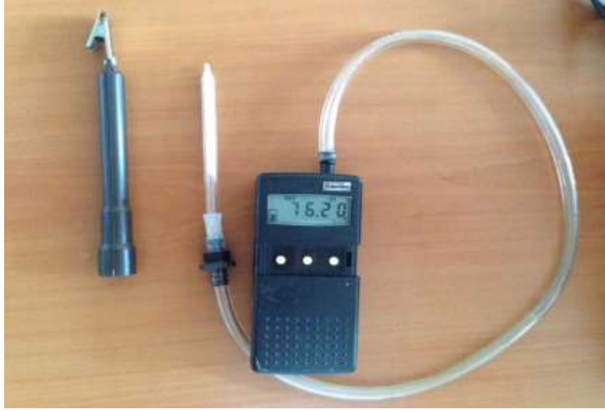
Resim 3.4. Pocket Pump Kişisel Hava Örneklemesi Pompası, Silika Jel Tüp, Silika Jel Tüp Başlığı
