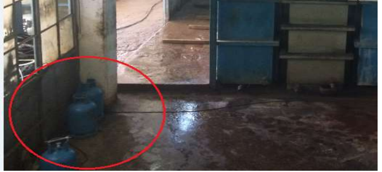
Resim 4.18. Uygun Şekilde Depolanmamış Tüpler
