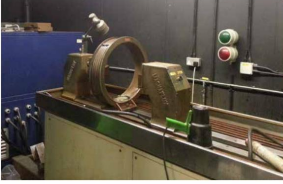
(a) (b) Şekil 4.13. (a) Degaussing (manyetik etkisini nötrleştirme) bobini (b) Sürme aracı ile iş parçasının bobin içersine verildiği degaussing bobin
