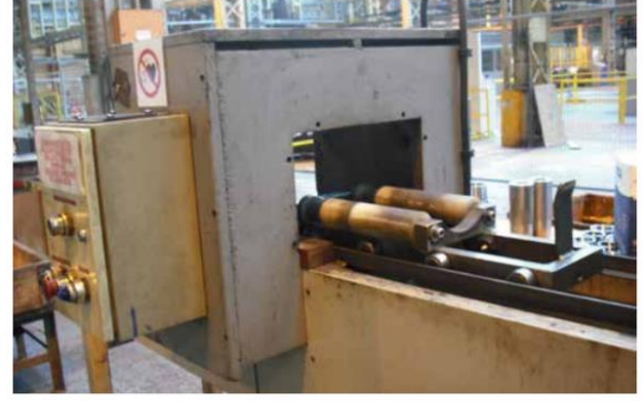
(a) (b) Şekil 4.13. (a) Degaussing (manyetik etkisini nötrleştirme) bobini (b) Sürme aracı ile iş parçasının bobin içersine verildiği degaussing bobin
