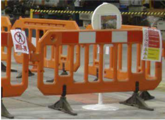
Şekil 4.5. Kurulum sırasında oluşan geçici güçlü elektromanyetik alanlara erişimi kısıtlamak için engeller ve uyarı işaretleri
