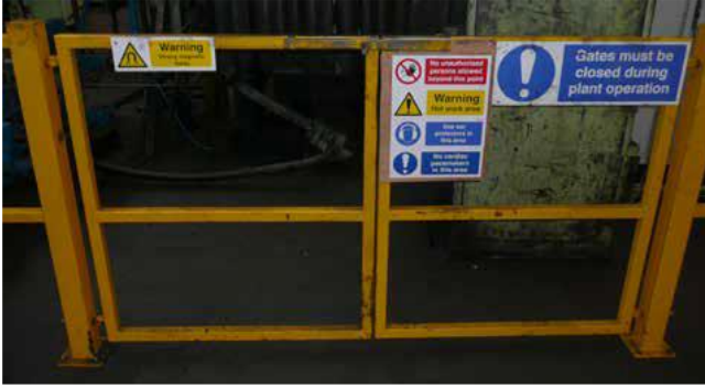
Şekil 4.1. Manyetik alanın güçlü olduğu alana erişimi kısıtlamak için kullanılan basit bir hareketli koruma.
