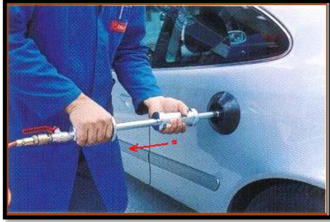
Resim 2.3. Vakumlu pnömatik çekirme cihazı ile parça onarımı [11]
