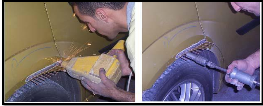
Resim 2.5. Perçin kaynatarak düzeltme [11]
