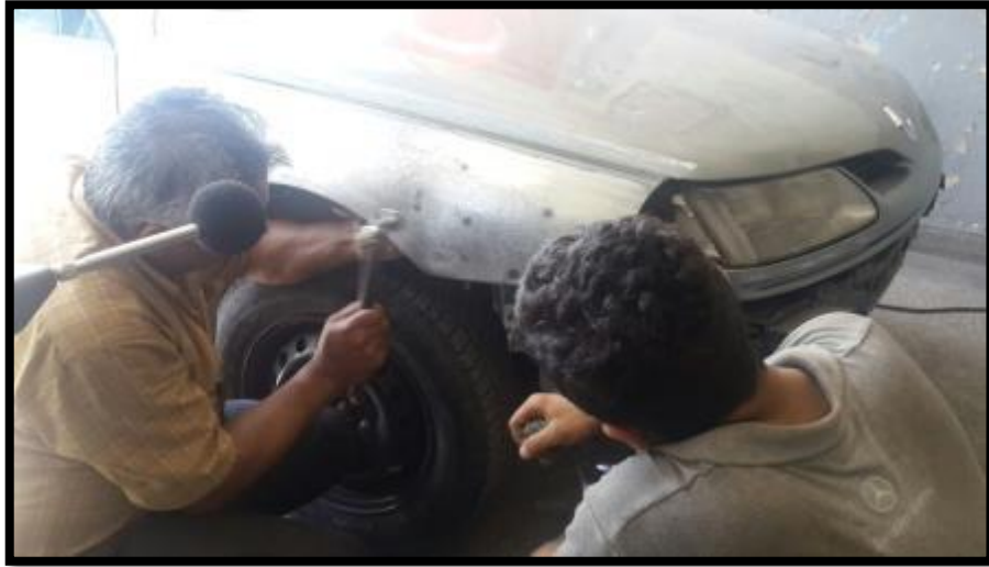
Resim 2.1. Çekiç ve dayama ile düzeltme
